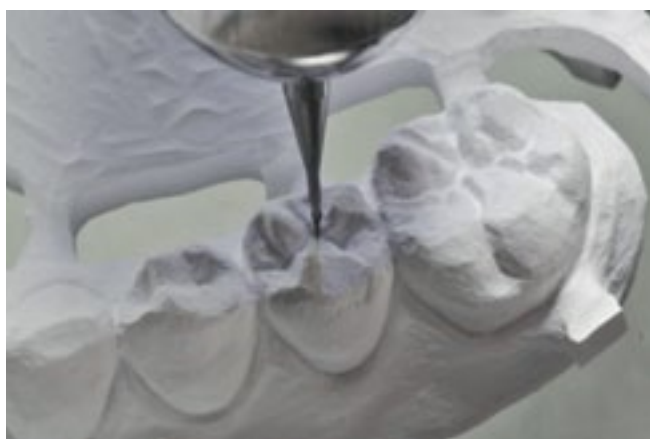
Fig. 16b Surfaces occlusales en cours de fraisage par copiage à l'aide du Zirkograph.
