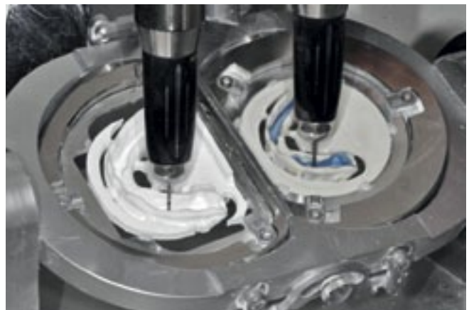
Fig. 16a Processus manuel de fraisage par copiage (à gauche, unité de fraisage et pièce brute; à droite le palpeur sur le modèle de la prothèse).
