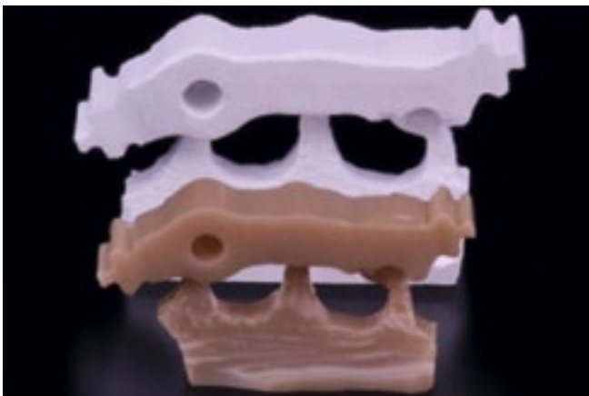
Fig. 13 Barre en zircone à l'état brut («vert») (en haut) et après le frittage (en bas): illustration de la différence des dimensions en fonction du rétrécissement volumique de 20% lors du frittage.
